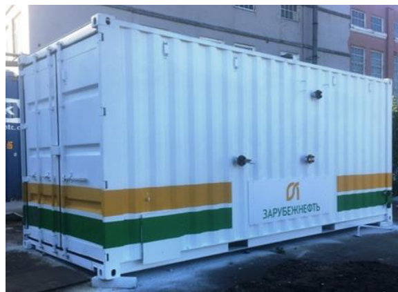
Рис. 2. Внешний вид тестовой мобильной установки каталитической сероочистки ПНГ на базе 20-футового контейнера
