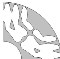
Рис. 6. Результат оптимизации при минимизации максимальных значениях напряжения и распределении веса 30 кг / м
