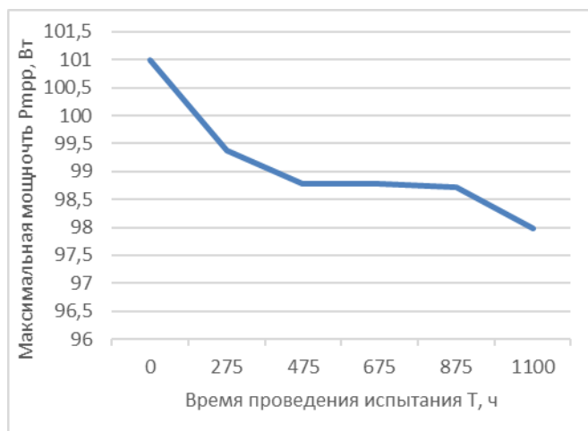
Рис. 7. График зависимости P_{\text{мрр}} ФЭМ от времени пройденных в климатической камере при прохождении испытания влажное тепло
