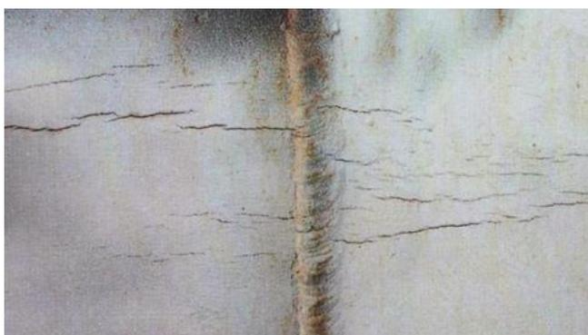
Рис. 1. Продольные коррозионные трещины в зоне сварного стыка
