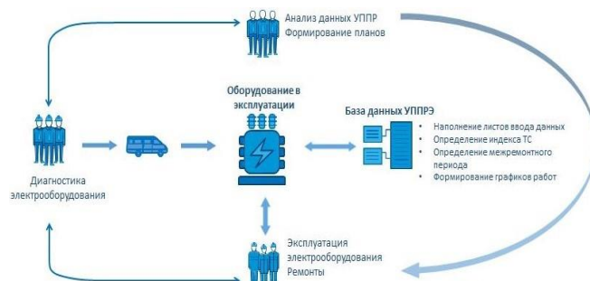
Рис. 3. Схема диагностики и осмотра электрооборудования.
