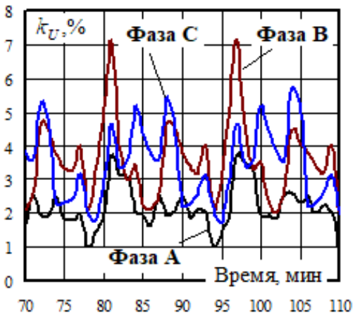
Рис. 13. Суммарные коэффициенты гармоник на шинах 220 кВ ТП 3
