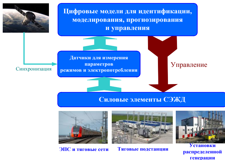
Рис. 1. Структура кибер-физической системы электроснабжения
