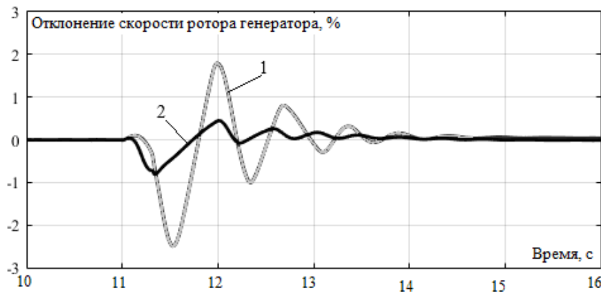
Рис. 9. Отклонение скорости ротора генератора при удаленном трехфазном КЗ длительностью 0,3 с: 1 – применение типовых АРВ и АРС (перерегулирование \sigma=2,5\% , t_p=3 с); 2 – применение АРВ и АРС на основе обученных нейронных сетей ( \sigma=0,8\% , t_p=2,5 с)
