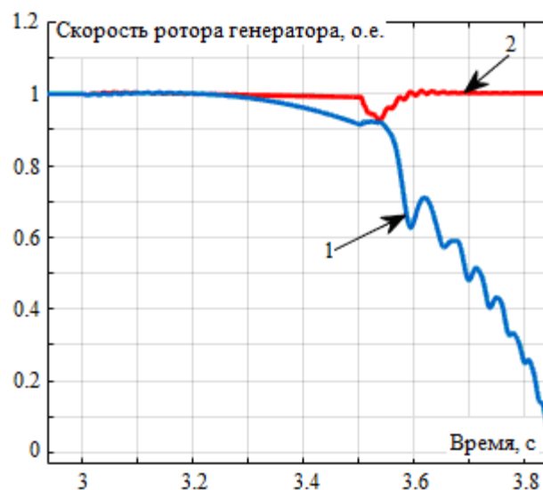
Рис. 7. Осциллограммы скорости ротора СГ при кратковременном КЗ: 1 – без вариации настроек АРВ и АРС; 2 – с использованием нечеткого регулятора
