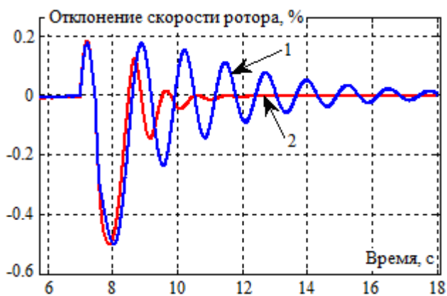
Рис. 6. Отклонение скорости вращения ротора генератора: 1 – без вариации настроек регуляторов (время переходного процесса t_p=10 с); 2 – с использованием нечеткого регулятора ( t_p=4 с)
