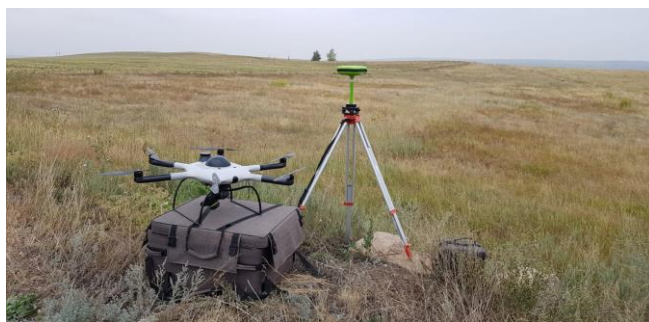
Рис. 4. БПЛА Supercam X6M2 и GNSS-приемник JAVAD Triumph-1
