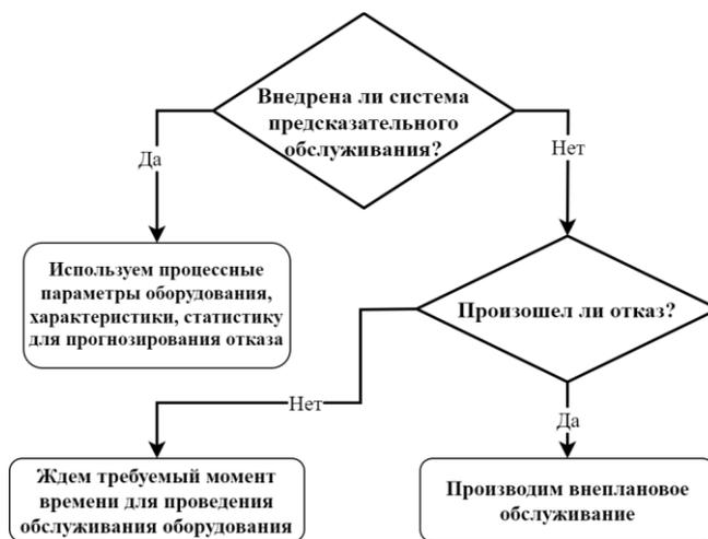
Рис. 1. Процесс оценки технического состояния оборудования
