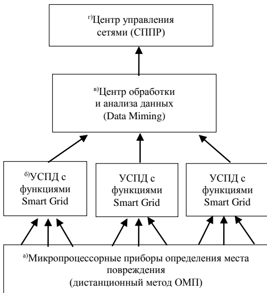
Рис. 1. Перспективная блок-схема развития сервиса ОМП сетевой компании: а – уровень измерительно-информационного комплекса; б – уровень информационно-вычислительного комплекса энергообъекта (УСПД – устройства системы передачи данных); в – уровень информационно-вычислительного комплекса ЦОД; г – уровень автоматизированного рабочего места (АРМ)
