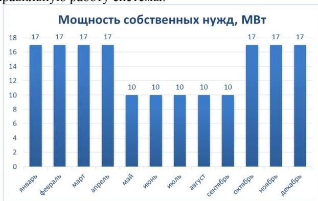
Рис. 3. Расход мощности на собственные нужды парогазового блока 220 Мвт в течение года
